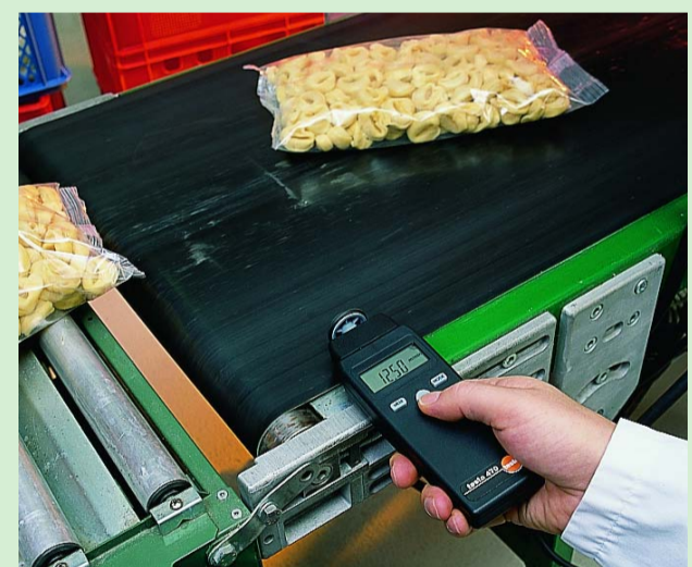
Измерения скорости/длины с использованием testo 470
