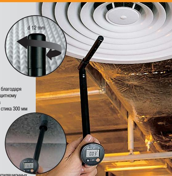
Задача сенсора благодаря поворотному защитному колпачку , длина измерительного стика 300 мм
